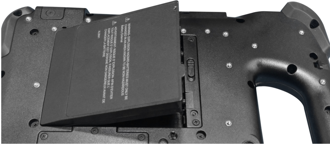
그림 4 배터리 교체
